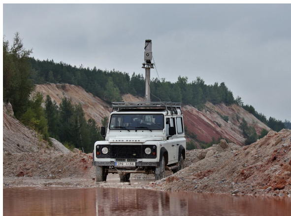
Obr. 7.2: Laserscanning v povrchovém lomu pomocí skeneru Riegl LMS-Z420i
