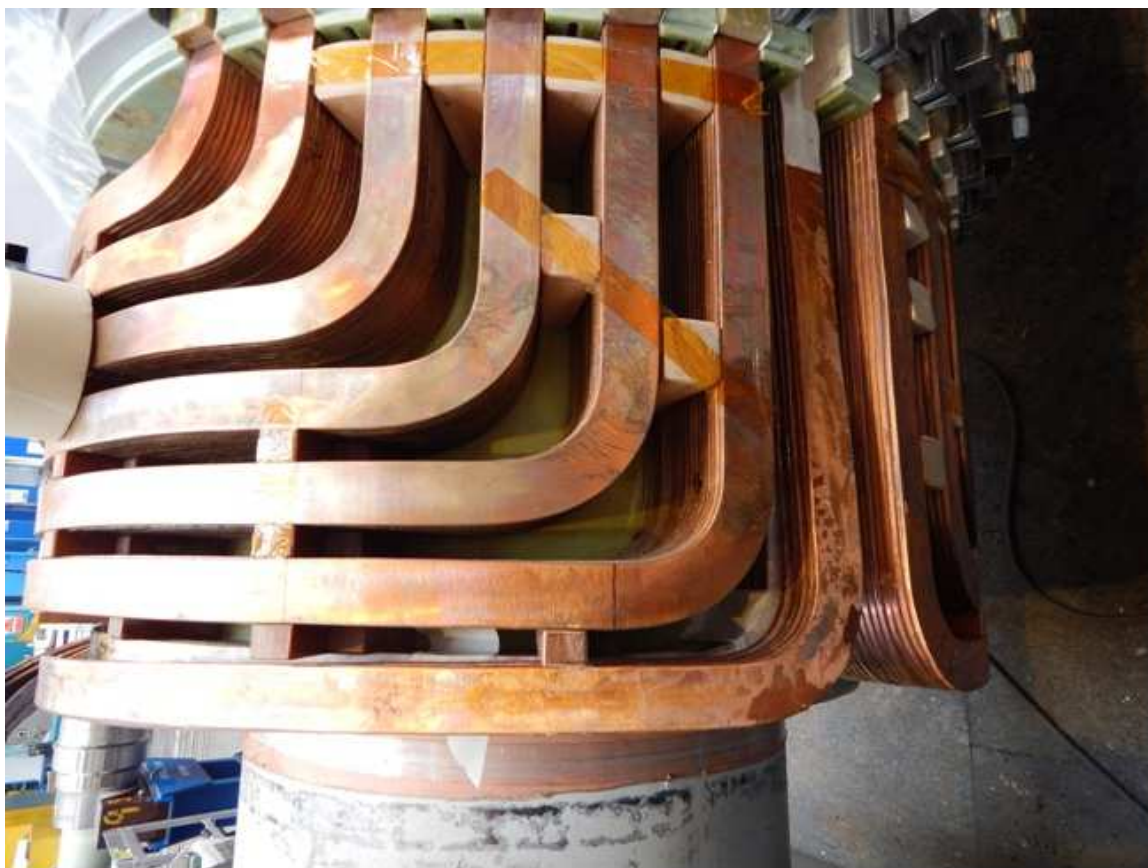
Obr. 2: Záběr na blokace čel vinutí rotoru
