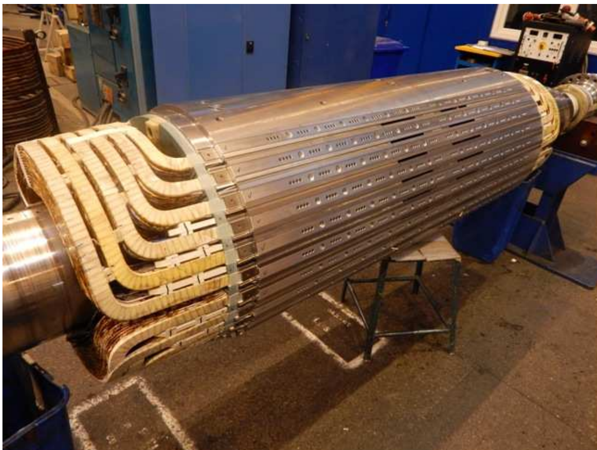
Obr. 1: Izolace čel vinutí rotoru
