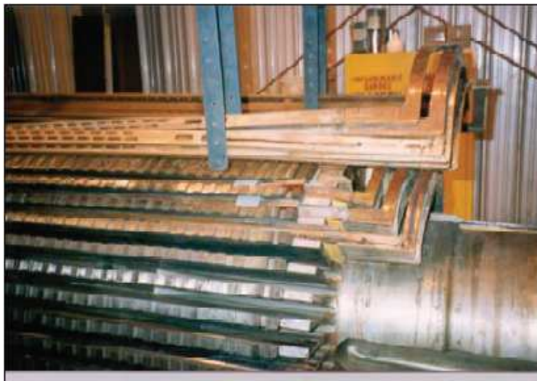
Obr. 4: Běžné pólové vinutí, jak střední části, tak i čela vinutí, některé závity jsou vysunuty z drážek
