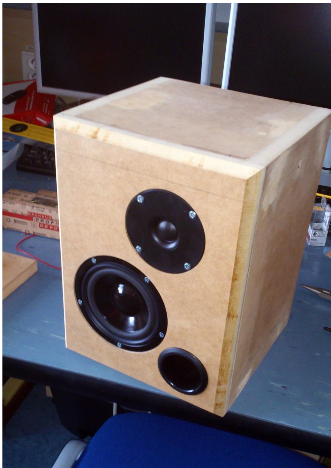
Obr. E7: Osazená soustava.
