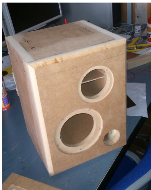
Obr. E3: Neosazená ozvučnice.
