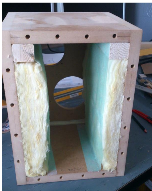
Obr. E5: Umístění tlumení v ozvučnici.
