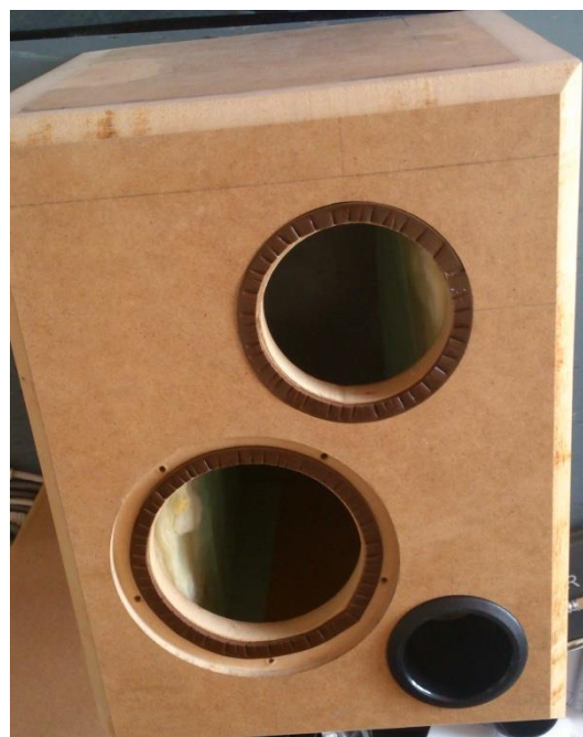
Obr. E6: Nalepené těsnění pod měniči.
