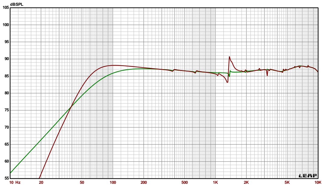
Obr. 3: Frekvenční charakteristiky soustavy s nátrubkem (červený průběh) a bez (zelený průběh).
