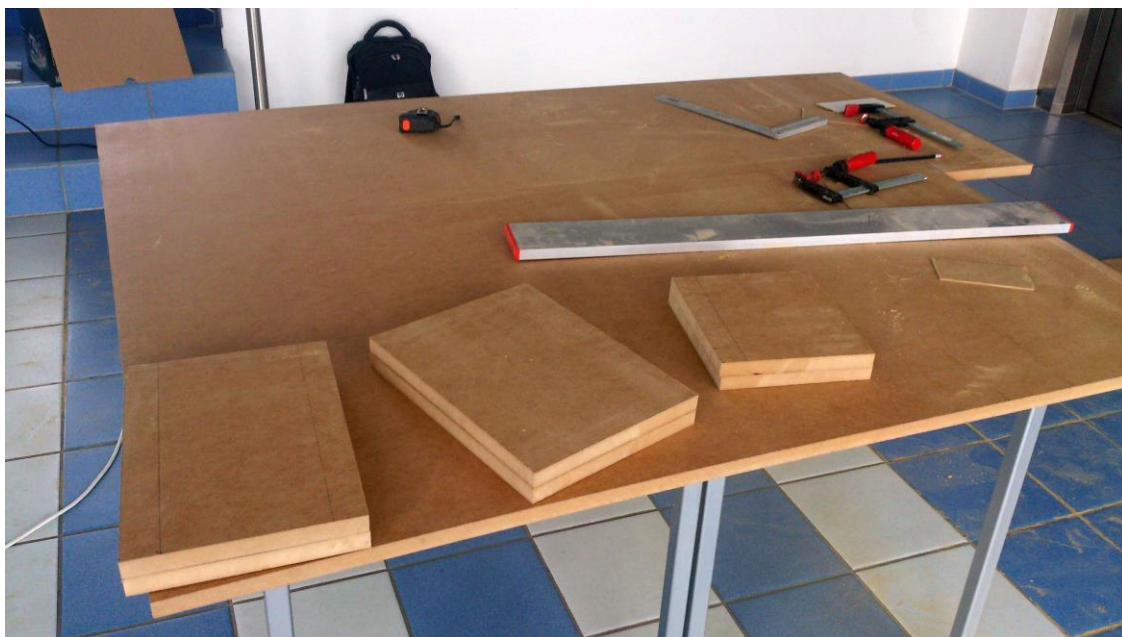
Obr. E1: Nařezané desky ozvučnice.
