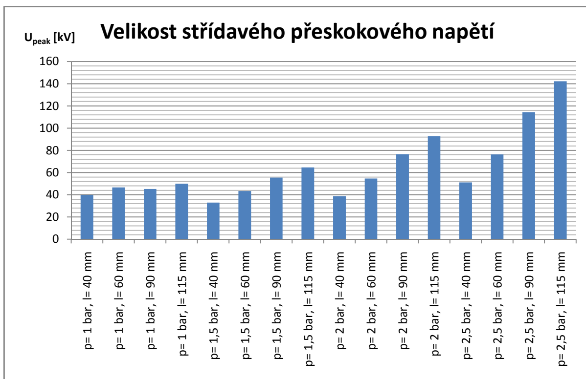
Obr. 24 Velikost vrcholového průrazného střídavého napětí v závislosti na tlaku při různých vzdálenostech elektrod
