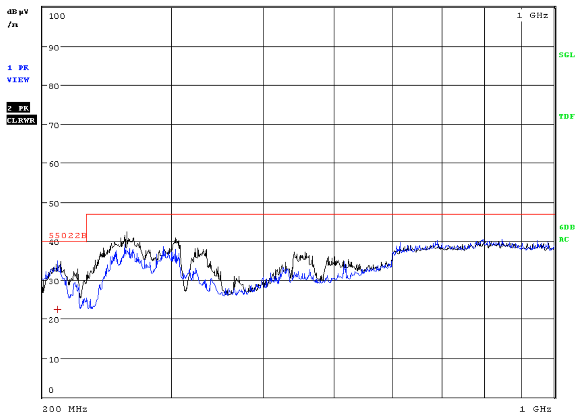
Obr. D3 – Elektromag. emise v rozsahu - 200MHz až 1GHz, anténa vertikálně
