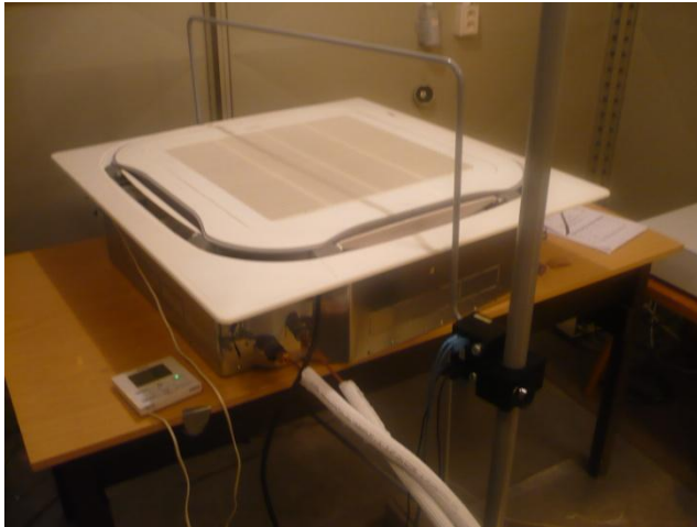
Obr. 22 – Umístění a orientace zkušební cívky
