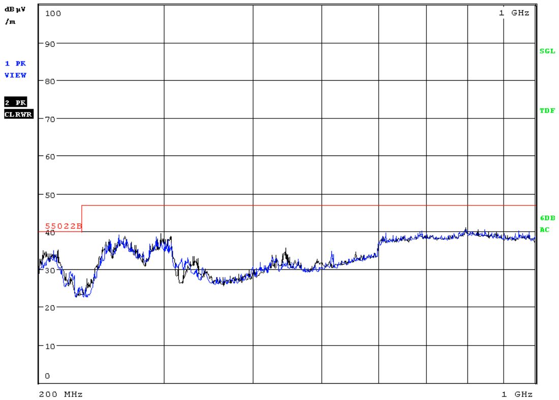
Obr. C3 – Elektromag. emise v rozsahu - 200MHz až 1GHz, anténa vertikálně
