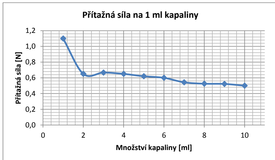
Obr. 10 Přitažná síla na 1 ml kapaliny
