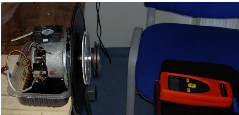
Obr. 31 Měření zrychlení se setrvačником
