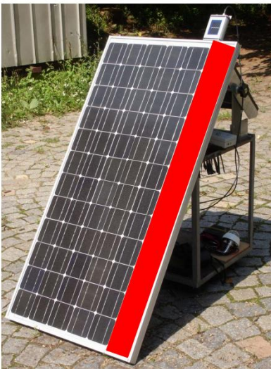
Obr. 27: Zastínění (ohřátí) PV panelu s třemi bypass diody případně umístěného na výšku [28]
