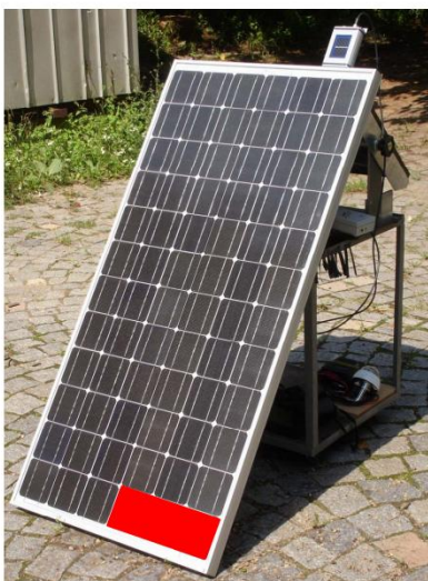
Obr. 28: Zastínění (ohřátí) PV panelu s třemi bypass diody případně umístěného na šířku [28]
