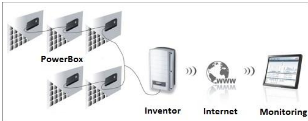
Obr. 61: Solární systém s použitím opitimizérů SolarEdge [51]
