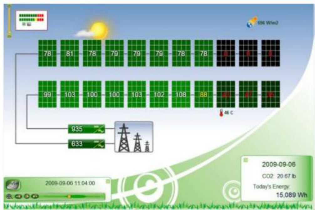
Obr. 23: Ukázka systému Sunlux Tigo a nerovnoměrného výkonu na jednotlivých PV panelech [19]
