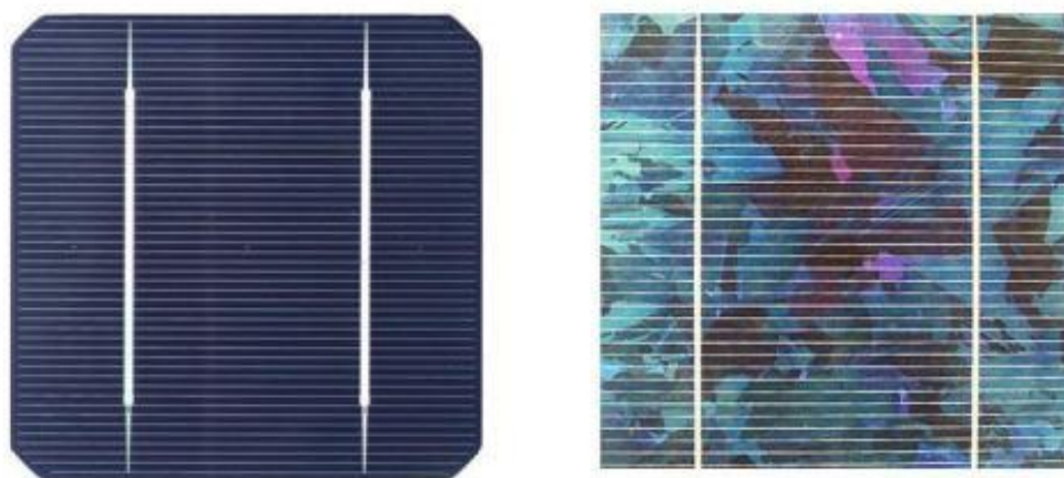
Obrázek 1.10 Porovnání vzhledu monokrystalického (vlevo) a polykrystalického Si článku [6].
