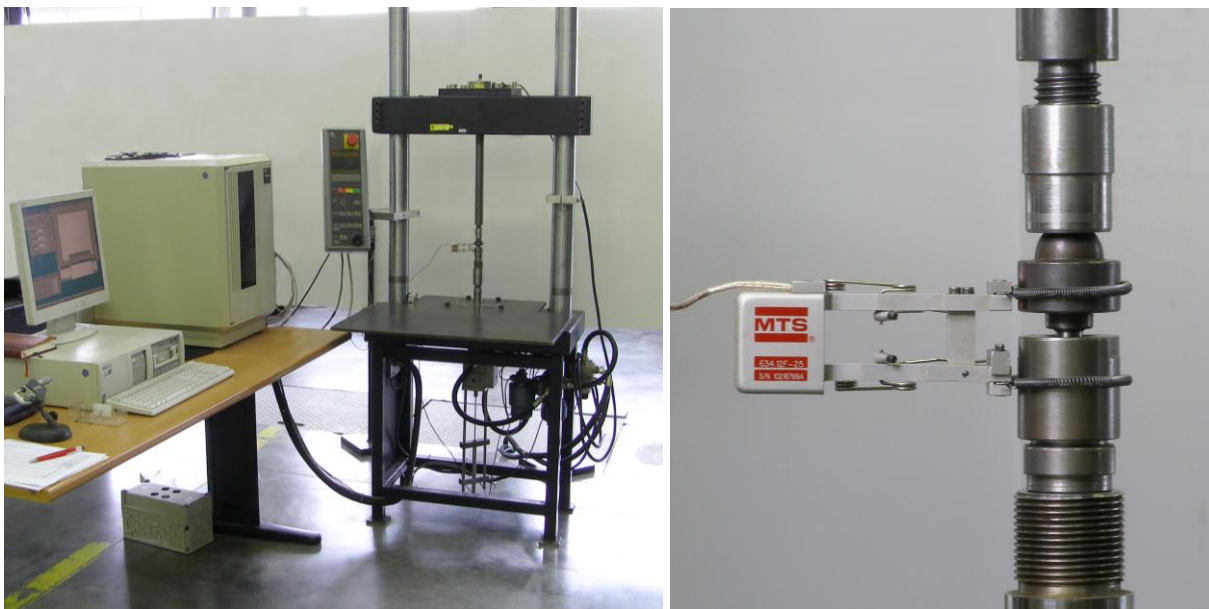
Obr. 98 Schéma uspořádání SPT; vlevo: Testovací stroj, vpravo: detail zkoušky
