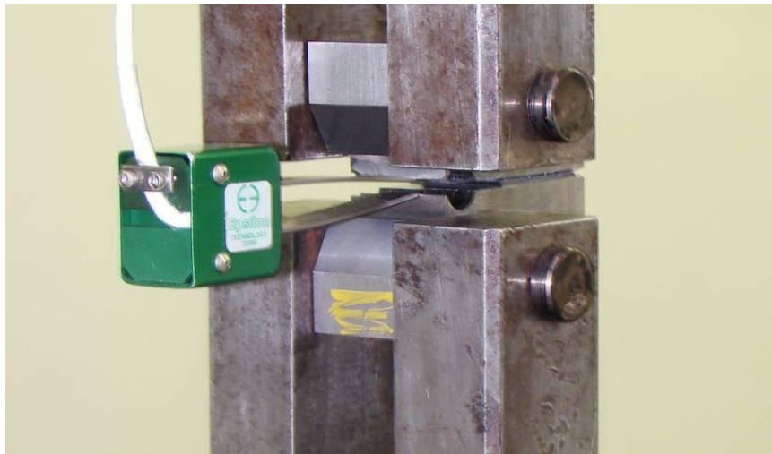
Obr. 23 Uspořádání zkoušky lomové houževnatosti
