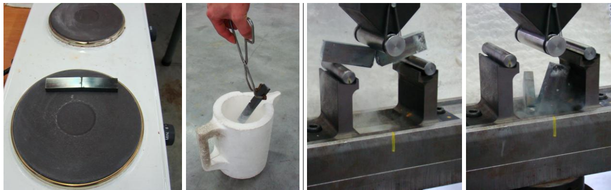
Obr. 80 Postup při zabarvování těles a křehkém dolomení po zkoušce LH
