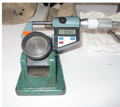
Obr. 46 Měřený vzorek v mikrometru s ideální tloušťkou [69]
