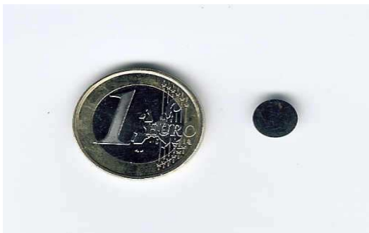
Obr. 22 Malý vzorek – penetrační test [29]
