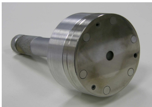
Obr. 44 Přípravek pro broušení vzorků [69]
