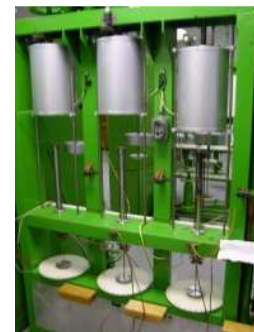
Obr. 88 Creepové standy upravené pro SPCT
