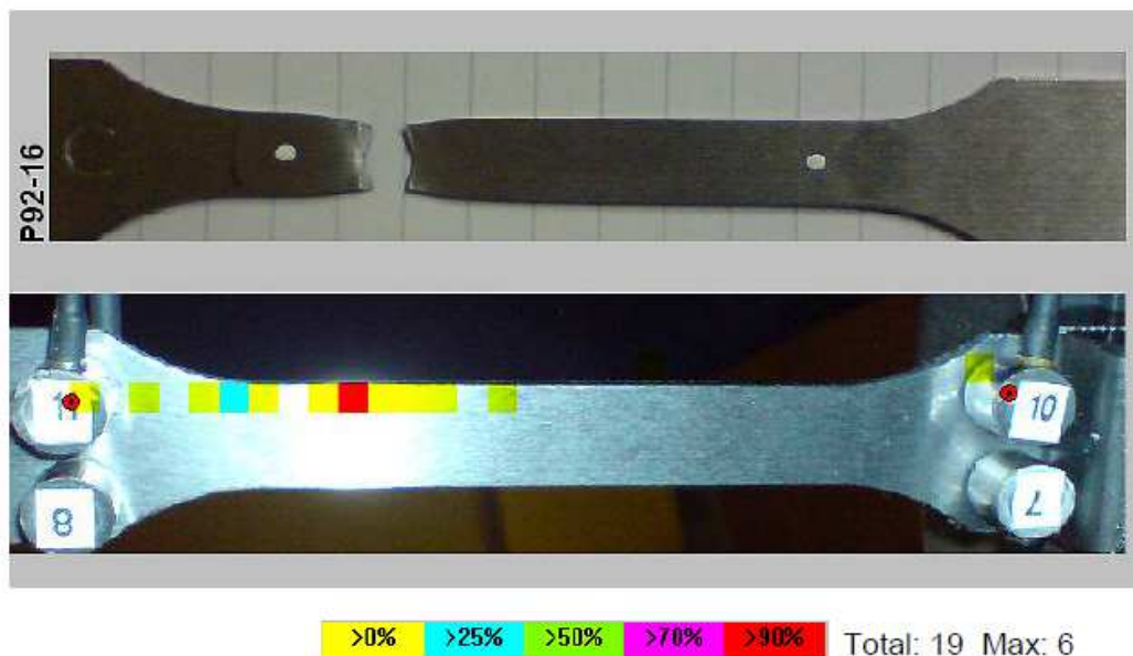
Obr. 120 Výsledek zkoušky tahem - nahoře pohled na přetržený vzorek, dole fotografie vzorku s promítnutou lokalizací emisních událostí podle intenzity signálu AE ( ocel P92 - 16) [66]
