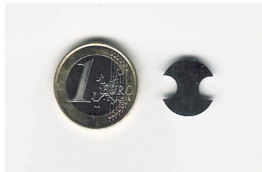
Obr. 23 Malý vzorek – zkouška únavy [29]
