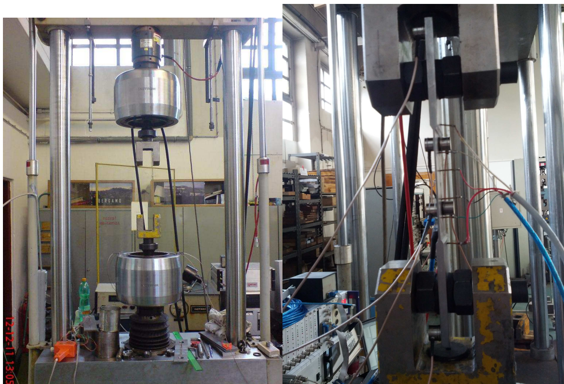
Obr. 110 Mechanické čelisti upnuté do hydraulických čelistí stroje MTS, detail upnutí vzorku [63]
