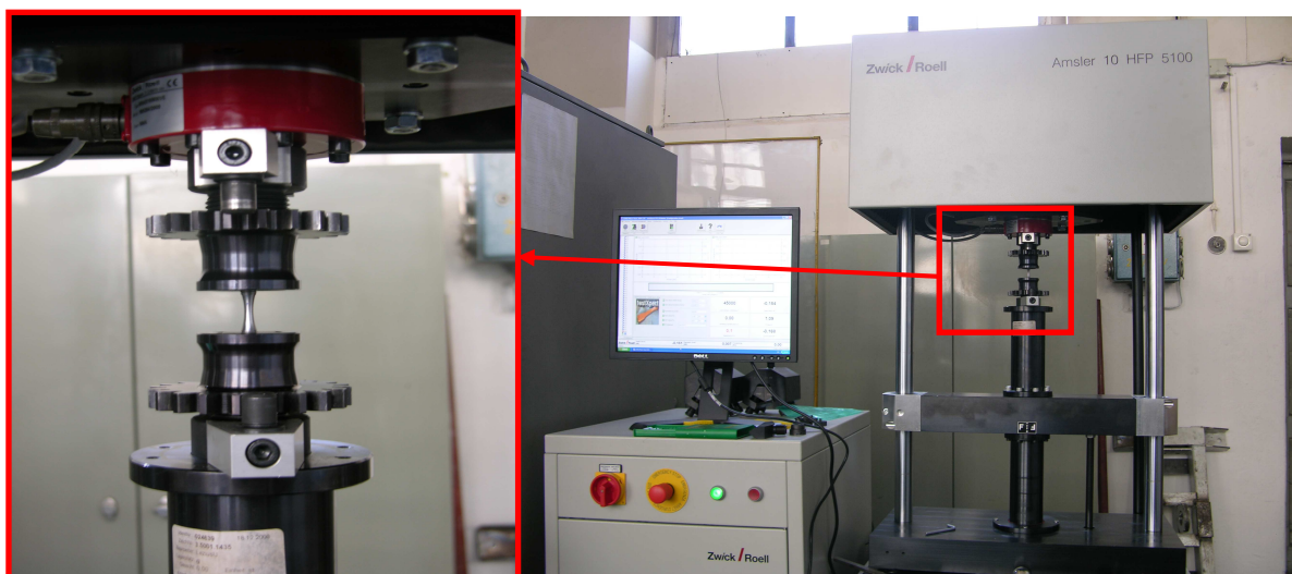
Obr. 95 Zkušební stroj Amsler 10 HFP 5100. Vlevo detail upnutí standardní zkušební tyče
