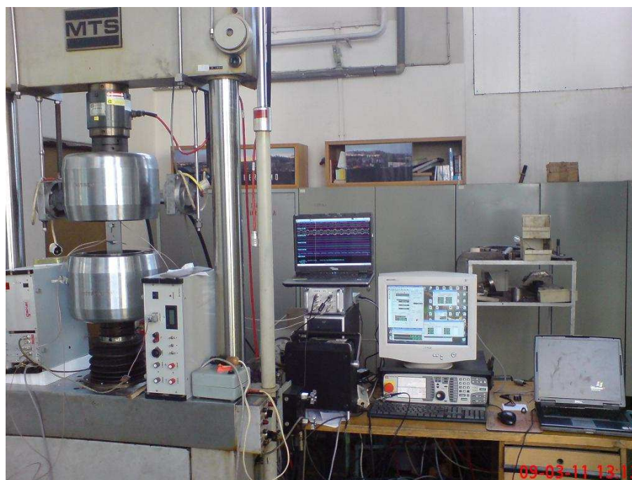
Obr. 109 Zkušební stroj, měřící aparatura DAKEL, ovládací jednotka stroje [63]
