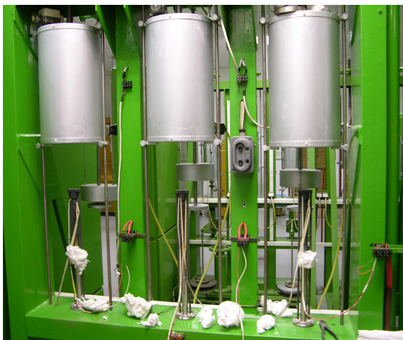
Obr. 79 Creepové zařízení, speciálně upravené pro SP creep testy
