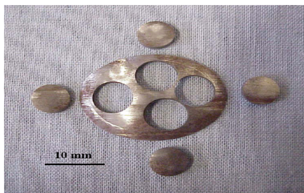
Obr. 26 Vzorky pro SP test odebrané ze zkušebního materiálu [29]
