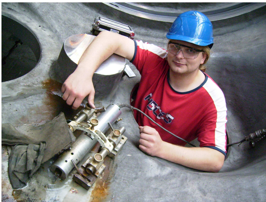
Obr. 30 Ukázka odběru materiálu ve ŠKODA POWER A DOOSAN company, firmou MATERIÁLOVÝ A METALURGICKÝ VÝZKUM s.r.o.
