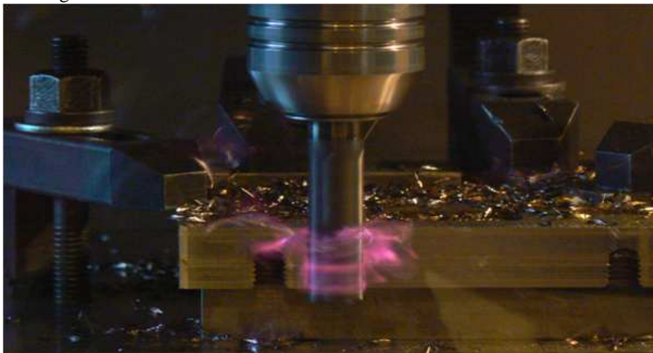
Obr. 4-2: Žhavé třísky při obrábění
