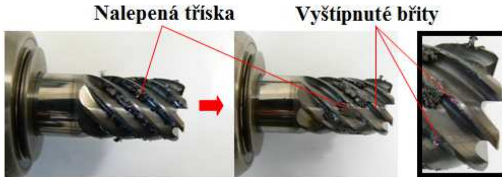
Obr. 3-25: Nalepování materiálu na břit, vylámání břitů
