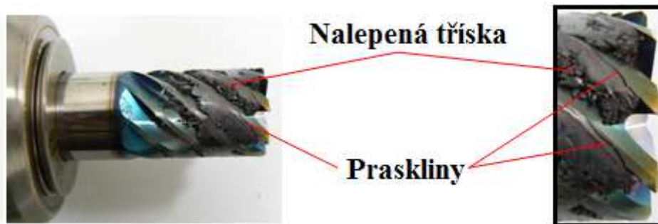
Obr. 3-21: Ucpání zubové mezery - výsledný stav nástroje
