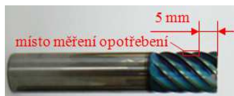
Obr. 3-18: Místo měření opotřebení nástroje
