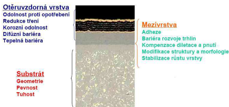
Obr. 2-12: Funkce systému tenká vrstva - substrát [21]
