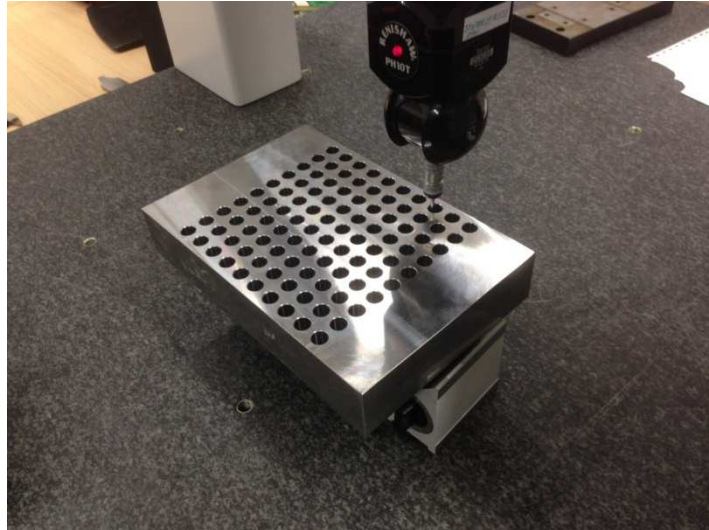
Obrázek 5-14 Měření geometrických odchylek pomocí 3D souřadnicového měřicího stroje LK-G90C.
