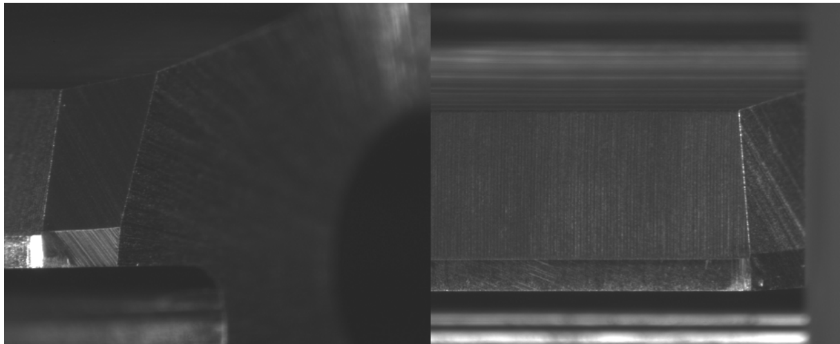
Obrázek 5-20 Stav výstružníku po 6,5 m vystružování. Vlevo je hlavní hřbet, kde je patrné opotřebení 60 \mu\text{m} , vpravo zase vedlejší hřbet bez výrazného opotřebení.
