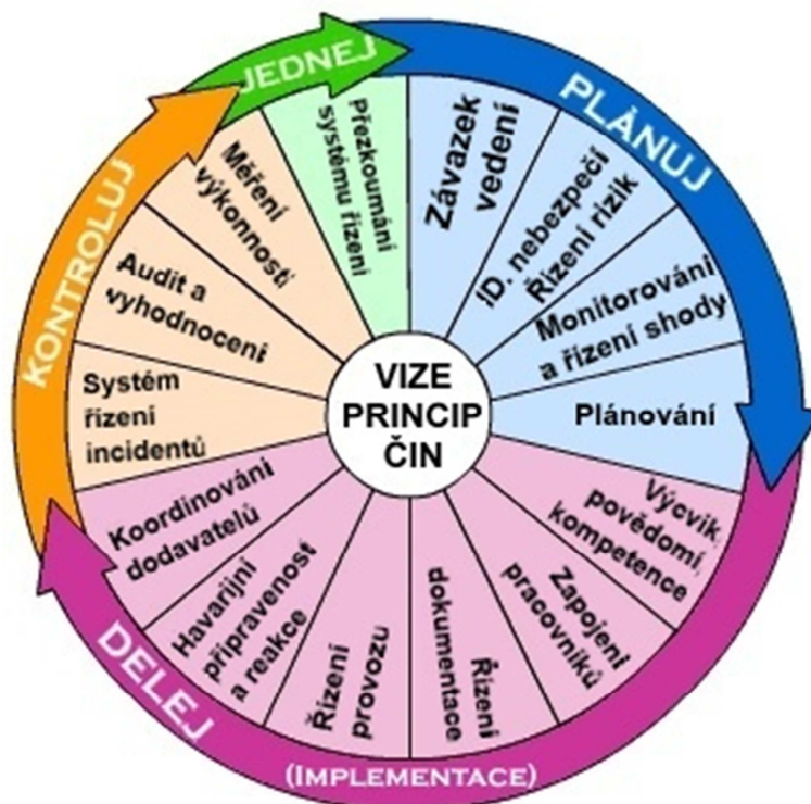
Obr. 2-2 Cyklus PDCA zaměřený na systém řízení BOZP
