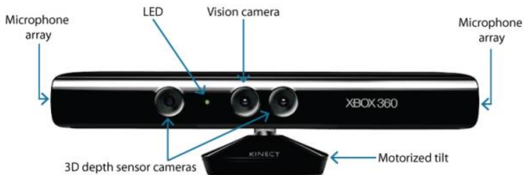
Obrázek 2.7 – Jednotlivé části Kinectu [9]
