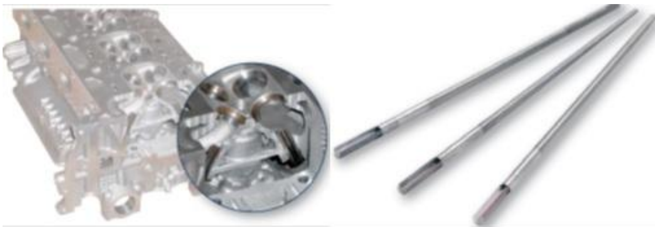
Obr. 1 Hlava motoru s detailem vodítek ventilů a patentované nástroje společnosti HAM-FINAL pro vystružování vodítek ventilů.
