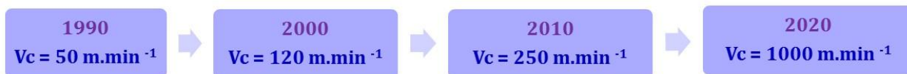
Obr. 6 Schéma vývoje úrovně řezné rychlosti při obrábění uhlíkové oceli v závislosti na vývoji řezných materiálů. Fig. 6 The development scheme of machining speed level by machining carbon steel depending on development of cutting materials.
