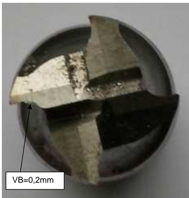
Obr. 8 Pohľad na chrbtové plochy zubov nástroja Fig. 8 Look on back surface of milling tool
