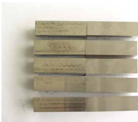
Obr. 4 Zkušební vzorky broušené metodou MQL s patrnými spáleninami (vlevo) a s chladicí kapalinou MICROCOOL 387 (vpravo)
