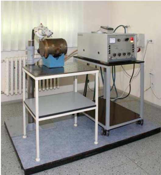
Obr. 2 Uspořádání rtg tenzometrické metody jedné expozice bez referenční látky.
