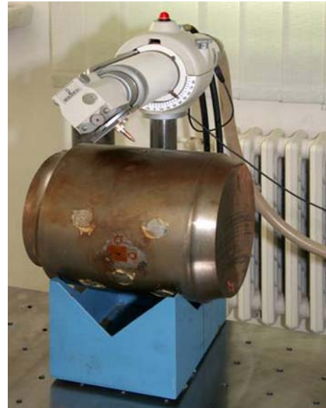
Obr. 3 Rtg zařízení FJFI ČVUT v Praze pro difrakční analýzu rozměrných vzorků.
