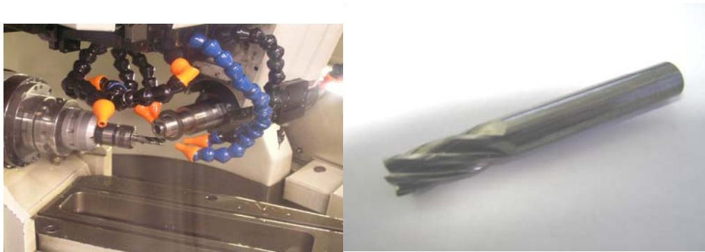
Obr.1 - Výroba frézovacího nástroje (vlevo) a fotografie vyrobené frézy (vpravo)
