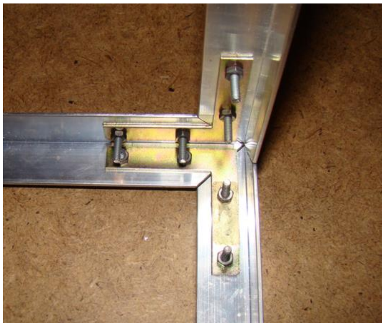
Obrázek 1 - Spojení tří profilů pomocí úhelníku
