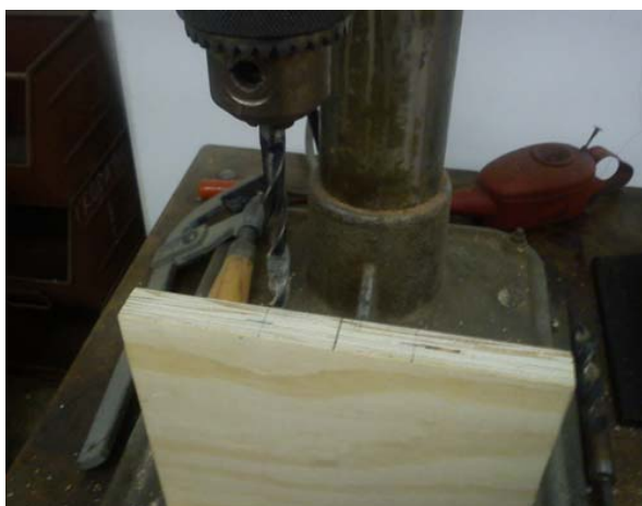
Obrázek 5 Vyvrtávání děr na spoje
