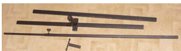
Obr.10 – Rozložené díly stojanu. Díly A, B, C, D, E. Díl „D“ je zasunutý v „C“.
