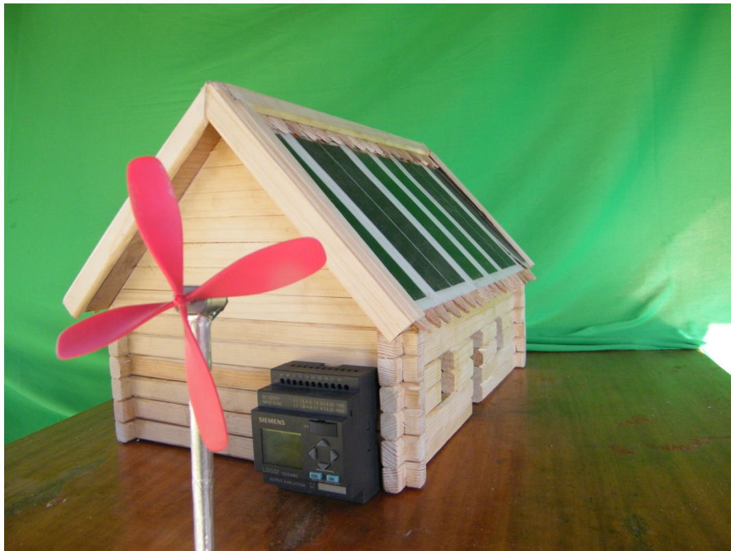
Obrázok 1 Pohľad na model domčeka, kde je vidno fotovoltaické panely, taktiež veternú turbínu a aj samostatný riadiaci systém
