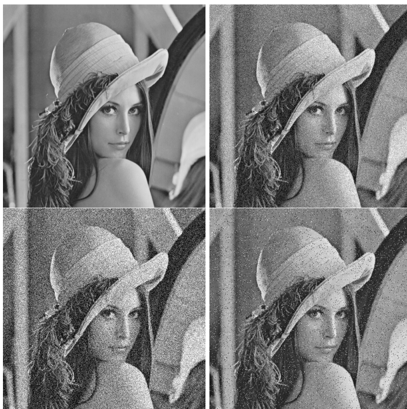
Obr. 6.19: Ukázky šumu - původní obrázek (vlevo nahoře, převzato z [22]); Gaussovský šum (vpravo nahoře, střední hodnota je rovna nule, rozptyl je roven \frac{1}{100} ); Gaussovský bílý šum (vlevo dole, SNR = 3 ); šum sůl a pepř (vpravo dole, hustota \frac{5}{100} ).
