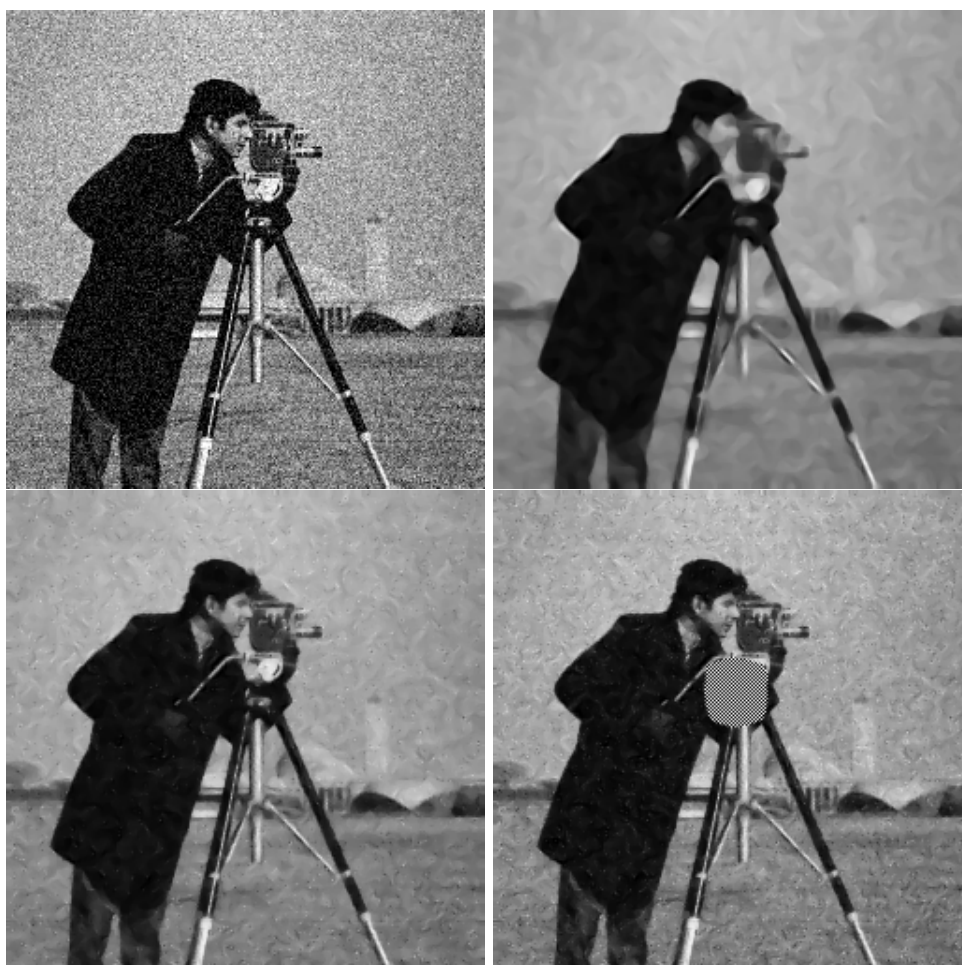
Obr. 6.24: Srovnání výstupů programu pro Gaussovský šum - kameraman - vstupní obrázek se šumem (nahore vlevo); řešení pro \lambda = 2 (vpravo nahore); řešení pro \lambda = 8 (vlevo dole); řešení pro \lambda = 12 (vpravo dole).
