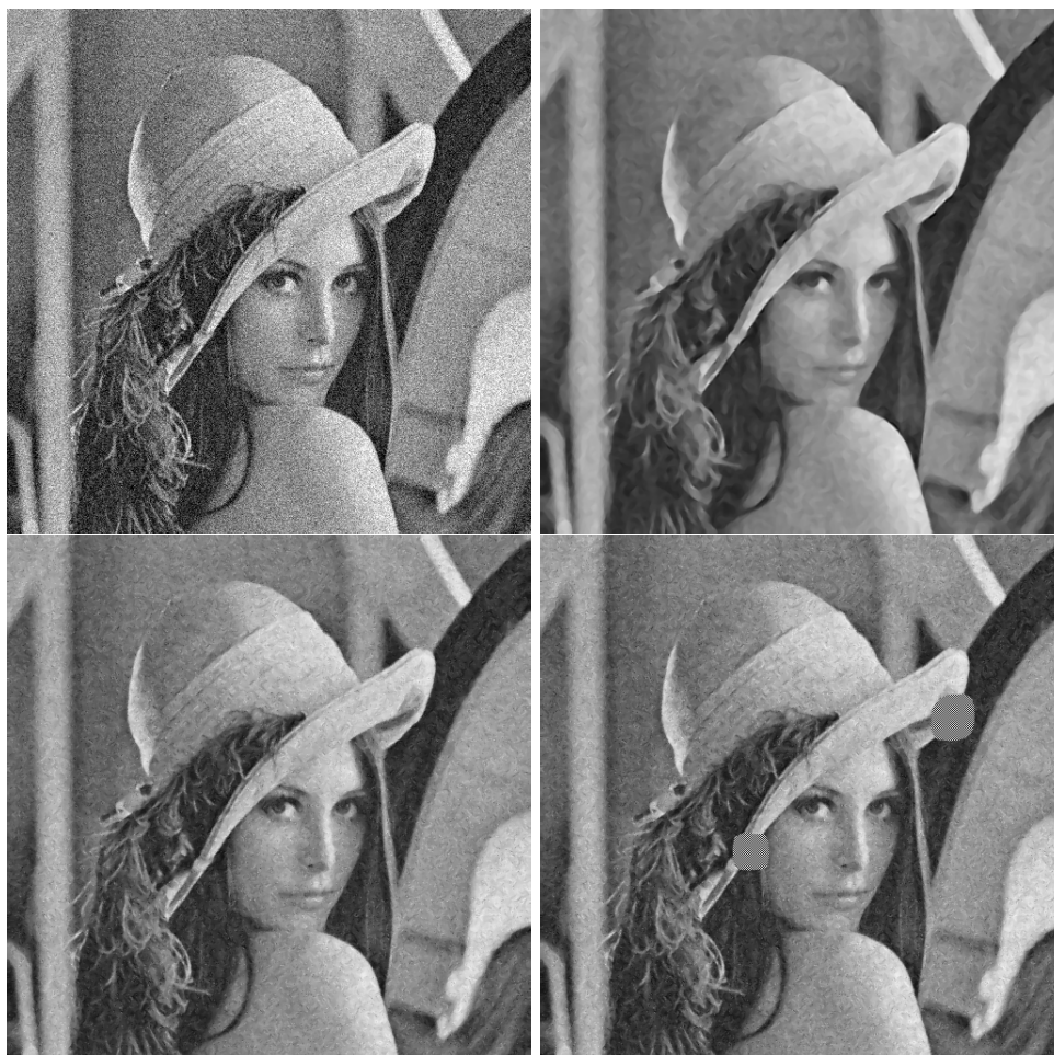
Obr. 6.21: Srovnání výstupů programu pro Gaussovský šum - Lena - vstupní obrázek se šumem (nahore vlevo); řešení pro \lambda = 2 (vpravo nahore); řešení pro \lambda = 12 (vlevo dole); řešení pro \lambda = 13 (vpravo dole).
