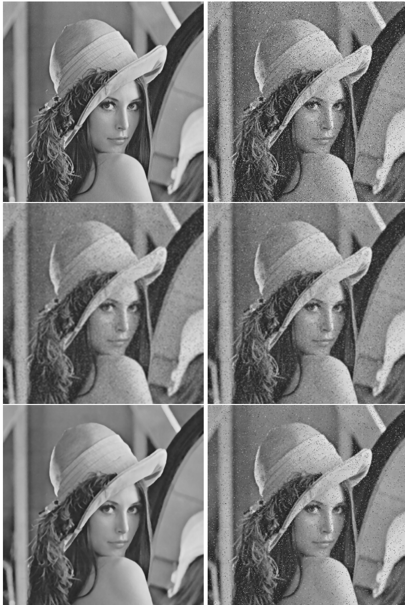
Obr. 6.28: Ukázky průměrování pro obrázek poškozený šumem „sůl a pepř“ - originální obrázek (vlevo nahoře); obrázek poškozený Gaussovským šumem (vpravo nahoře); rovnoměrná maska (vlevo uprostřed); Gaussova maska (vpravo uprostřed, [24]); medián (vlevo dole); bilaterální filtr (vpravo dole, [24]).
