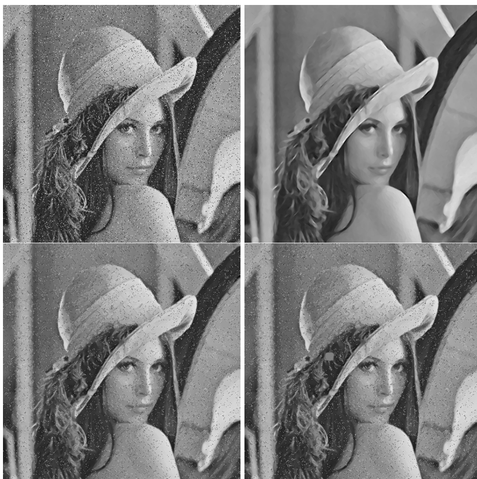
Obr. 6.22: Srovnání výstupů programu pro šum sůl a pepř (s hustotou \frac{5}{100} ) - Lena - vstupní obrázek se šumem (nahore vlevo); řešení pro \lambda = 1 (vpravo nahore); řešení pro \lambda = 7 (vlevo dole); řešení pro \lambda = 8 (vpravo dole).
