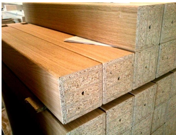
Obrázek 38: Otvor vyvrtaný na spodní straně nohy
