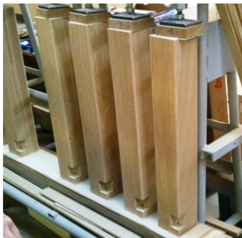
Obrázek 40: Nohy v lisu při lepení dýhy na čela nohou
