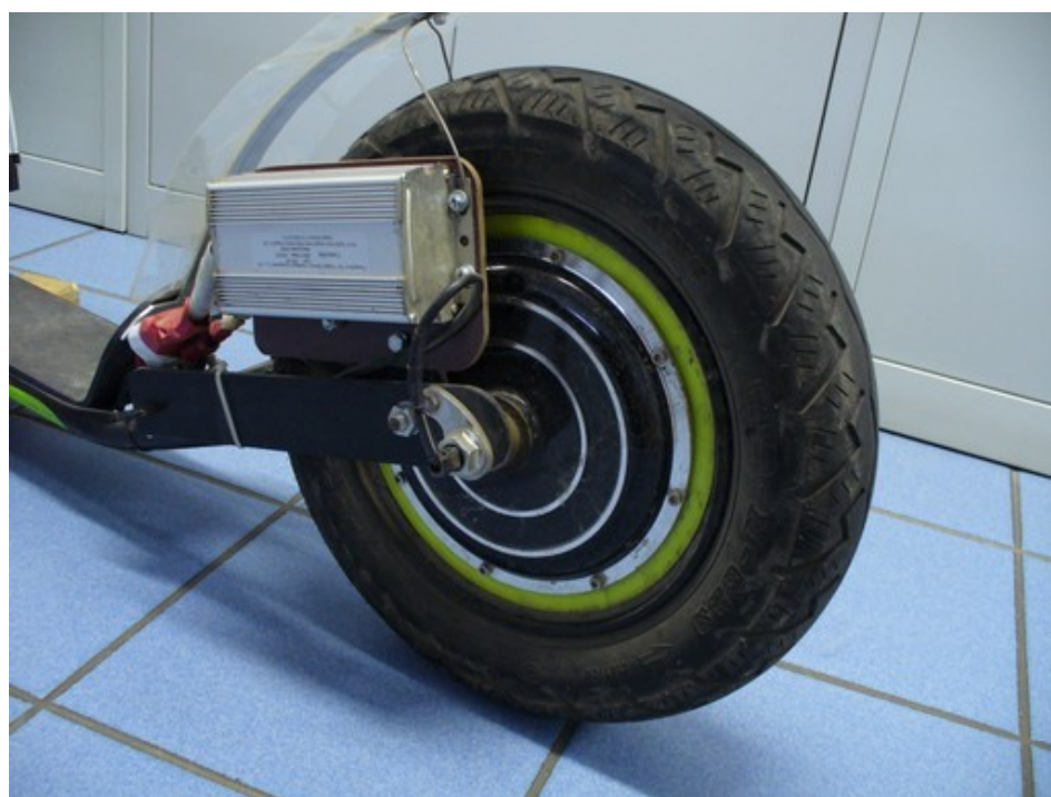
Obr. 7 Motor elektrické koloběžky
