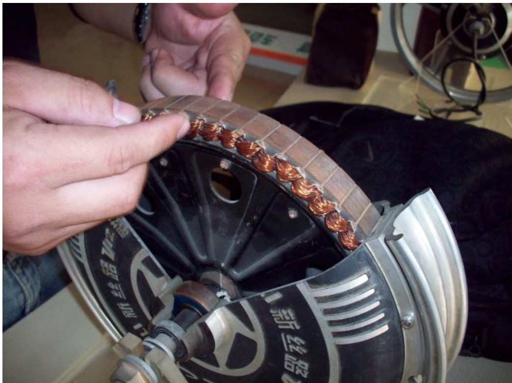
Obr. 6 Řez motorem podobné konstrukce [3]
