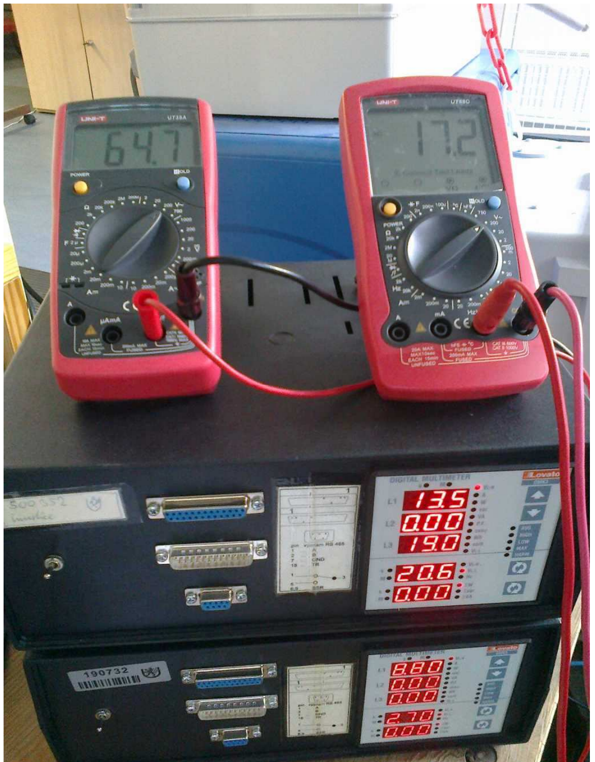
Obrázek 6 Měřící zařízení na výstupu transformátoru. Vlevo nahoře UNI-T UT39A, vpravo nahoře UNI-T UT58C a pod nimi dva DMK 32
