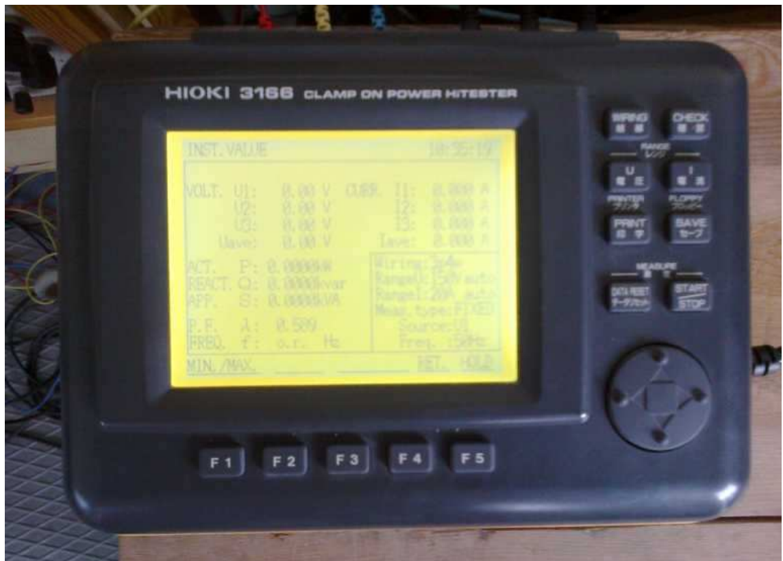
Obrázek 5 Hioki 3166 měřilo všechny vstupní veličiny na transformátoru
