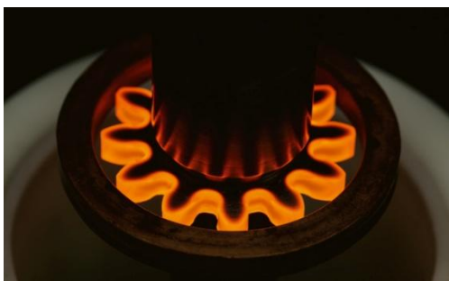
Obrázek 4: Kalení ozubeného kola [12]
