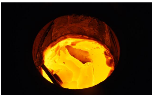
Obrázek 7: Tavení v indukční kelímkové peci [12]
