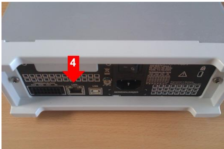
Obr. 20 Zkouška přímým výbojem do zadního panelu nad LAN konektor.
