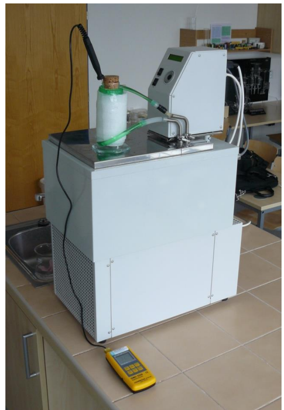
Obr 19. - Lázeň se zapojeným ext.obvodem
