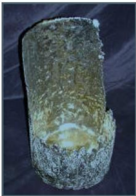
Obr. 3.1: Zbylá pevná vrstva po odlití roztaveného titanu z kelímku (převzato z [14])
