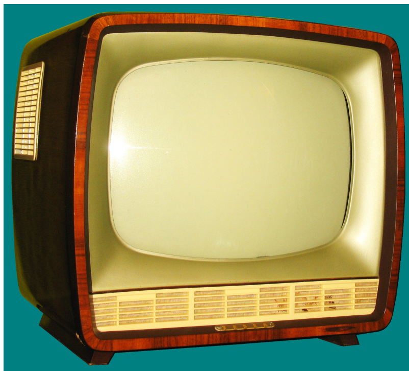
Obr.21: Můj televizor TESLA 4106U Ametyst. Mřížka na boku kryje hlavní reproduktor a ozdoba pod obrazovkou přidavný výškový elektrostatický. Obrazovka je ukryta za odnímatelným ochranným sklem.
