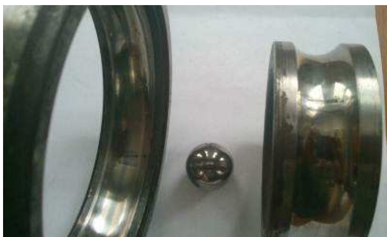
Obr.6.18 Vnější kroužek, kulička a vnitřní kroužek poškozeného ložiska
