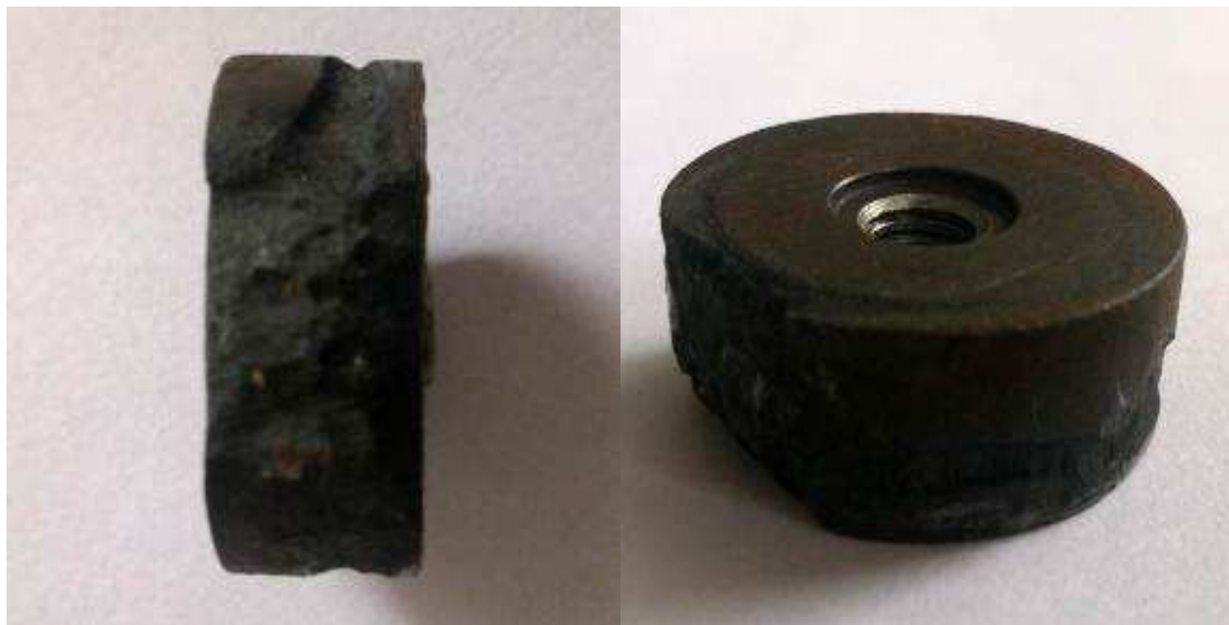
Obr.7.3. a 7.4. Nerezová magnetická podložka po působení sanitace
