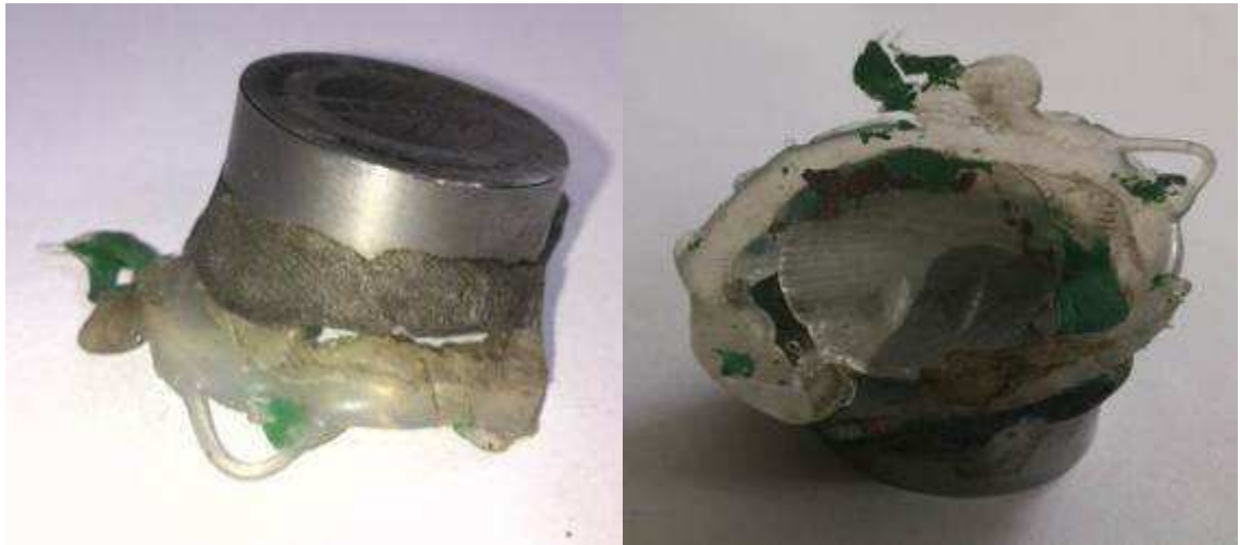
Obr..7.12 a 7.13. Měřící podložka po neodborné opravě
