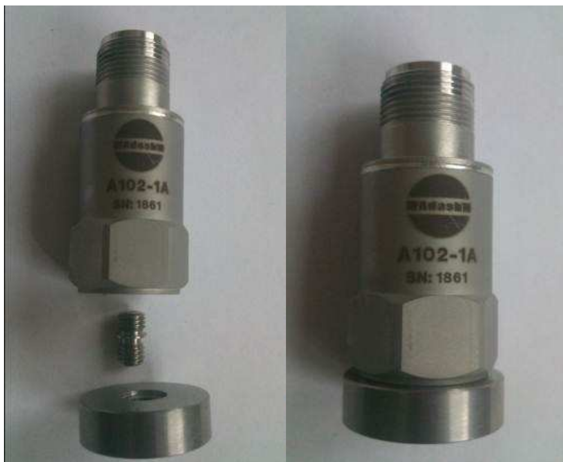
Obr. 5.5 a 6 Snímač se šroubem a podložkou
