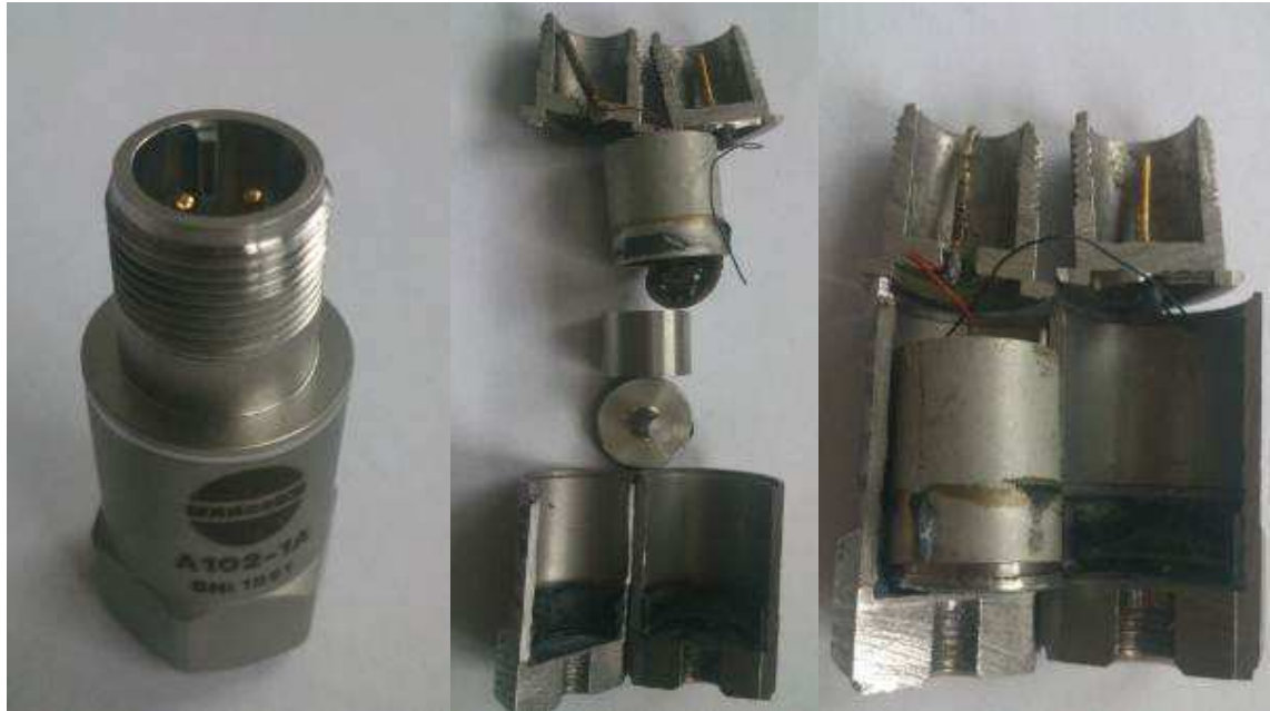
Obr. 5.7,8,9 Snímač a rozříznutý snímač.
