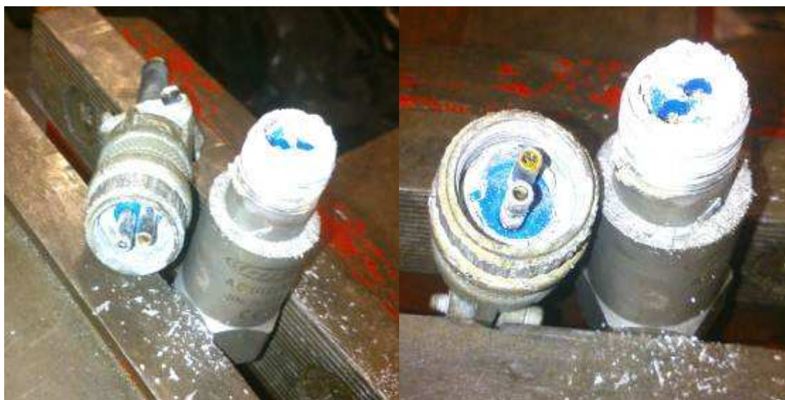
Obr.7.5. a 7.6. Konektory po působení sanitací
