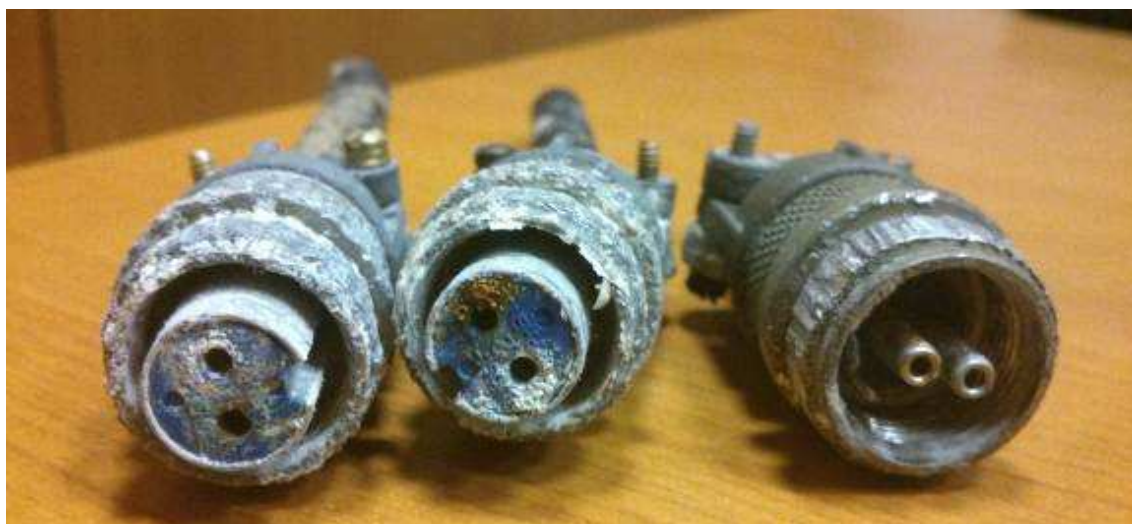
Obr.7.9. Konektory po působení sanitace
