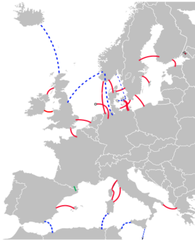
Obr. 23: HVDC linky v Evropě [40] (červené - existující, zelené - ve výstavbě, modré - navrhované)
