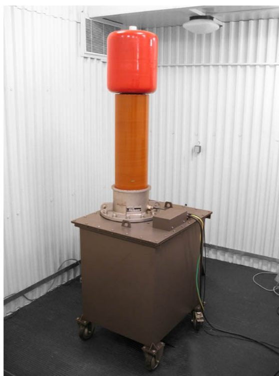
Obr. B.4 Bezvýbojový transformátor, který slouží jako zdroj napětí při měření částečných výbojů.
