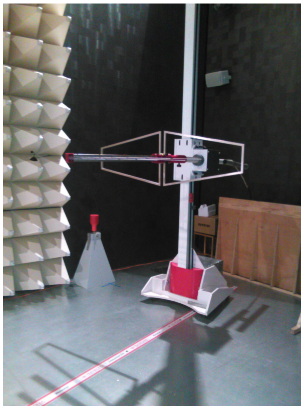
Obr. A.3 Anténa BTA-M pro měření rušení v pásmu od 30 MHz do 3 GHz.
