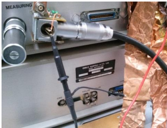
Obr. 15 Konektor koaxiálního kabelu 75 \Omega na vstupu vrcholového voltmetru, zemní svorka napěťové sondy připojena na pásek
