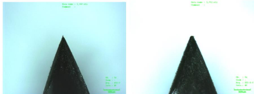
Obr. 62: Mikroskopický snímek jehly před (vlevo) a po měření (vpravo). Zdroj katedra
