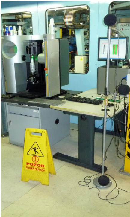
Obr. 2.8 Stojan pro měření výsledné teploty kulového teploměru
