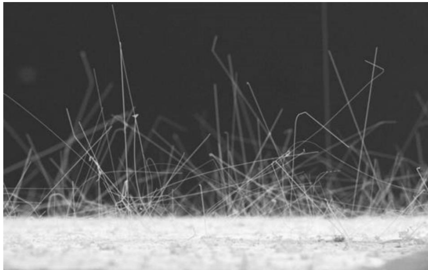
Obr. 9 Mikroskopický snímek cínových vláken (převzato z: [56])
