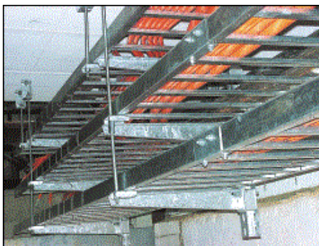
Obr. 12: Zkušební sestava před požární zkouškou. [30]
