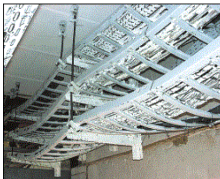
Obr. 13: Zkušební sestava - stav po požární zkoušce. [30]
