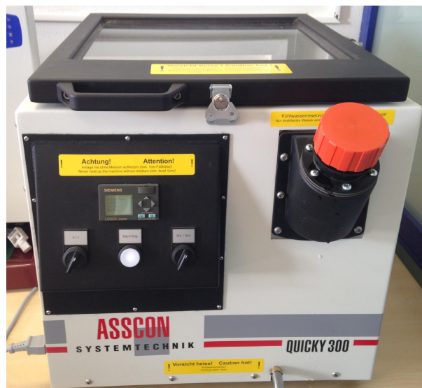
Obr. 3.7 Pájecí pec pro přetavení v horkých parách
