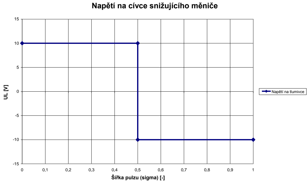
Obr. 7 Napětí na cívce u snižujícího měniče
