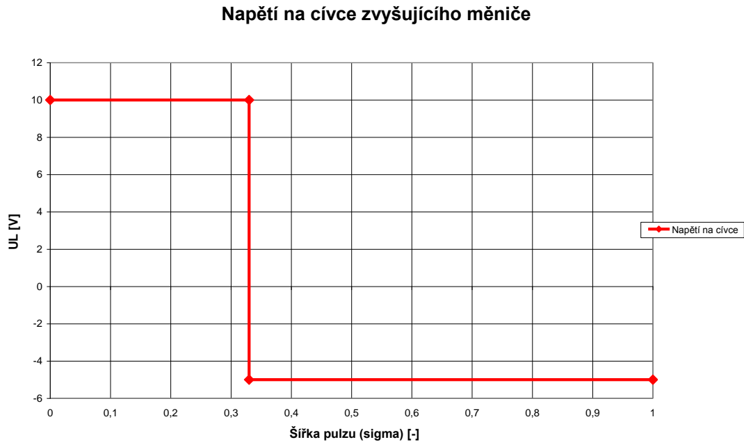
Obr. 15 Napětí na cívce u zvyšujícího měniče
