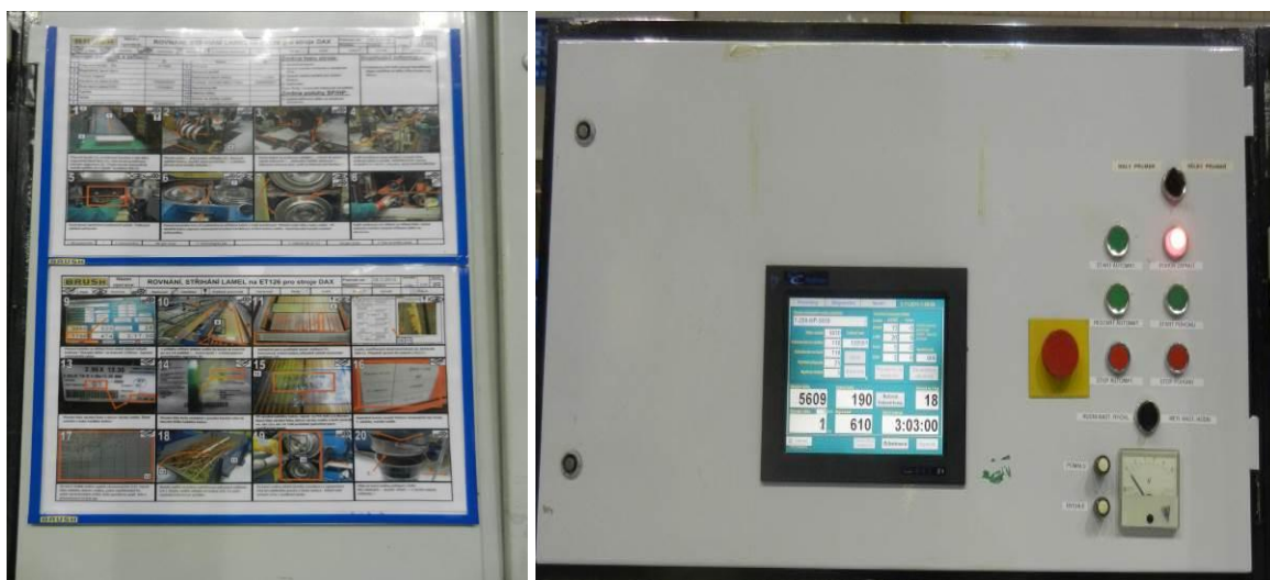
Obrázek 3.9: Displej a návodka stříhačky ET 126
