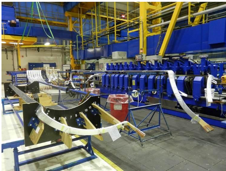
Obrázek 3.22: Pracoviště vytvrzení základu a hlavní izolace
