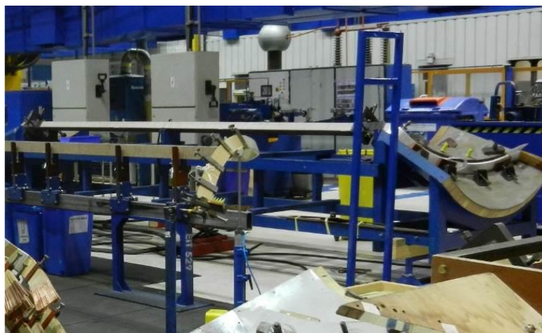
Obrázek 3.21: Pracoviště pro izolování základu a čel
