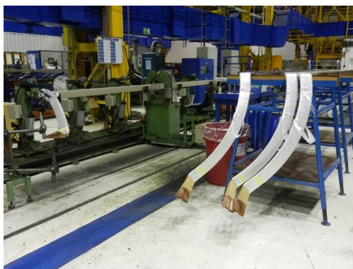
Obrázek 3.24: Pracoviště izolování rovné části
