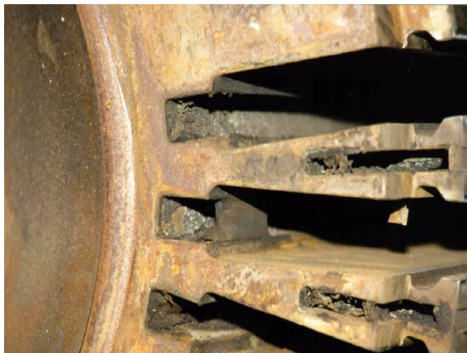
P 4.4 Znečištění a ucpání ventilačních kanálek vzduchem chlazeného stroje (převzato z [43])
