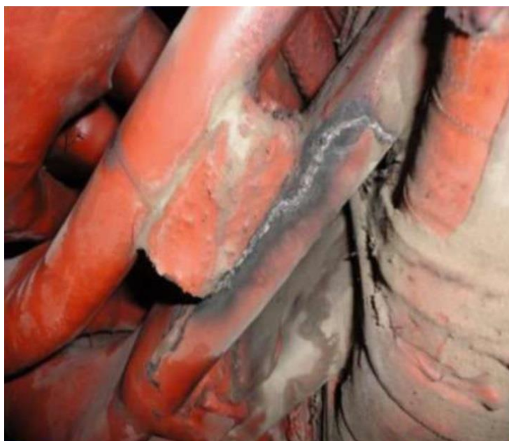
P 1.9 Kontaminace nečistotami a vlhkostí (převzato z [7])
