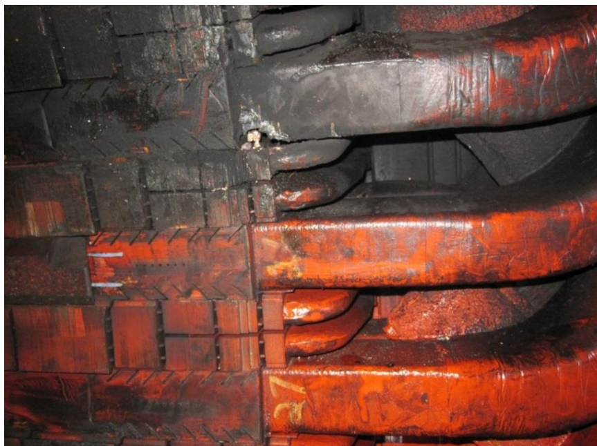
P 1.8 Zničení tyčí vinutí a jádra statoru zemním spojením (převzato z [43])
