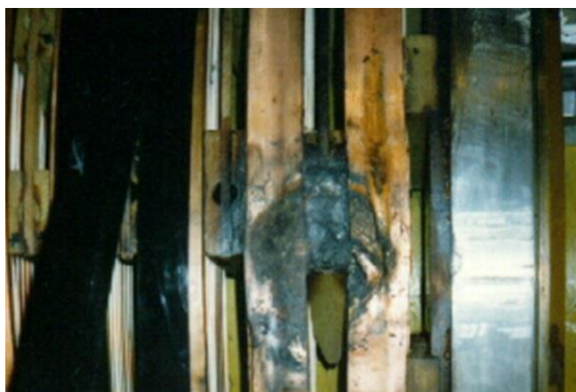
P 3.4 Zkrat mezi dvěma cívkami způsobil jejich roztavení (převzato z [35])
