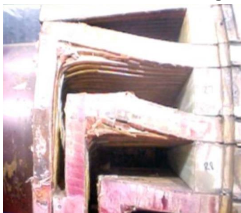
P 3.1 Zkrat vzniklý posunem krajního vodiče vlivem teplotního namáhání (převzato z [10])
