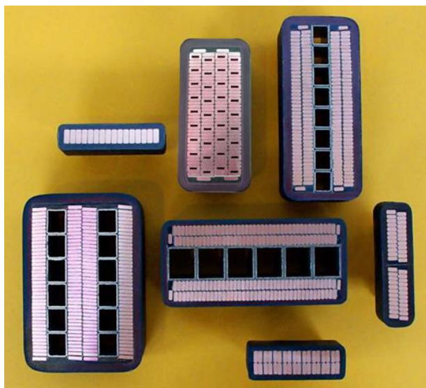
Obr. 1.7 Druhy a provedení Roeblových tyčí (převzato z [33])
