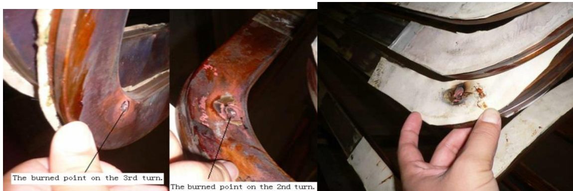
P 3.3 Mezizávitový zkrat mezi 2. a 3. závitem (převzato z [47])
