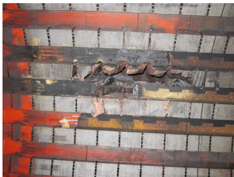
P 2.3 Neopravitelné roztavení jádra statoru (převzato z [43])
