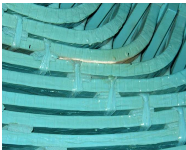
P 6.4 Částečné výboje na vývodech mezi jednotlivými fázemi vyššího napětí (převzato z [42])
