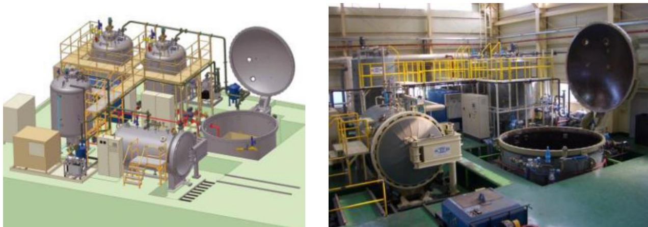
Obr. 2.2 Zařízení a vybavení pro technologii VPI (převzato z: [24])
