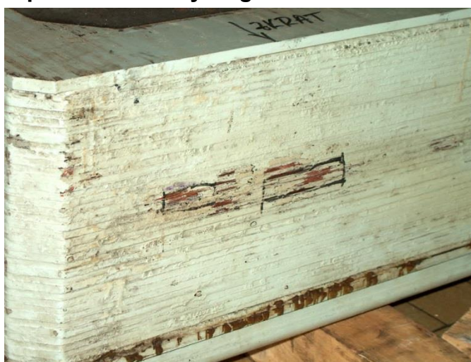
P 5.1 Mezizávitový zkrat na cívce pólu rotoru hydrogenerátoru [53]
