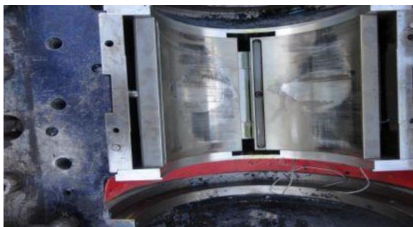
P 4.2 Porucha ložisek nerovnoměrným zatížením (převzato z [10])
