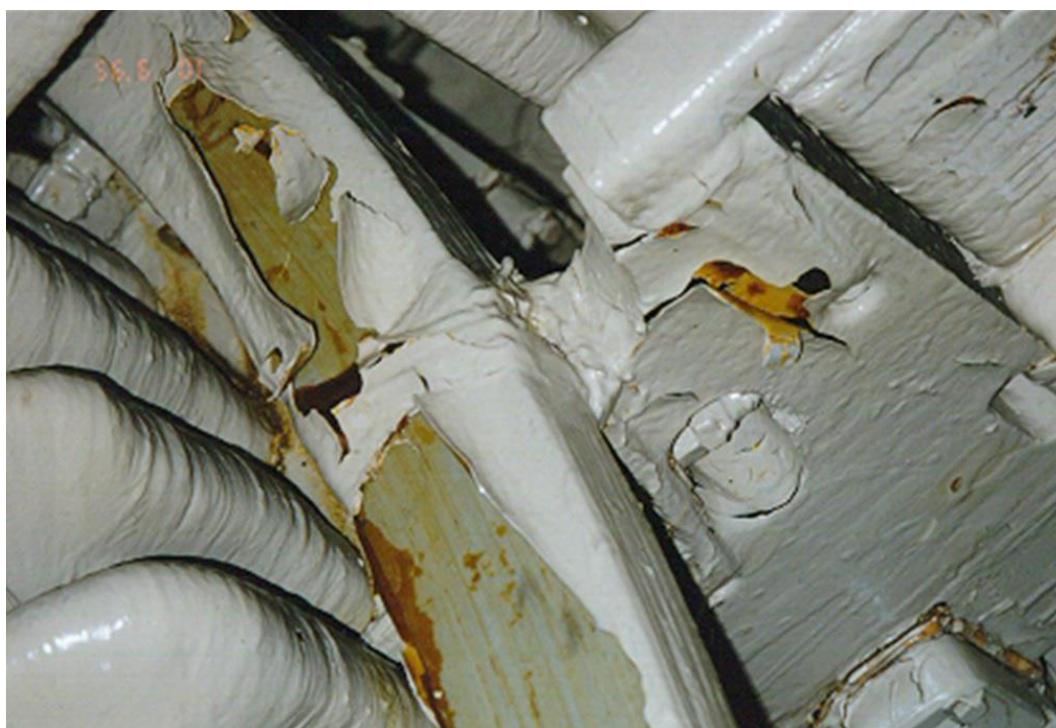
P 1.7 Zničená izolace tyče vinutí, ke které došlo po 2 hodinách provozu od celkového převnutí stroje (převzato z [43])
