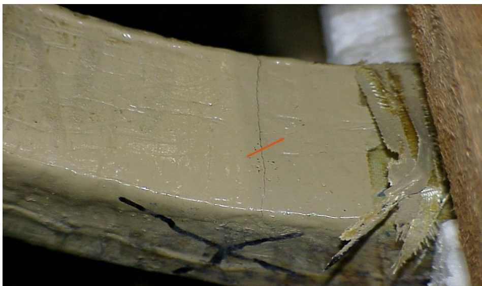
P 1.3 Závažná prasklina vzniklá vlivem zkratových proudů (převzato z [43])
