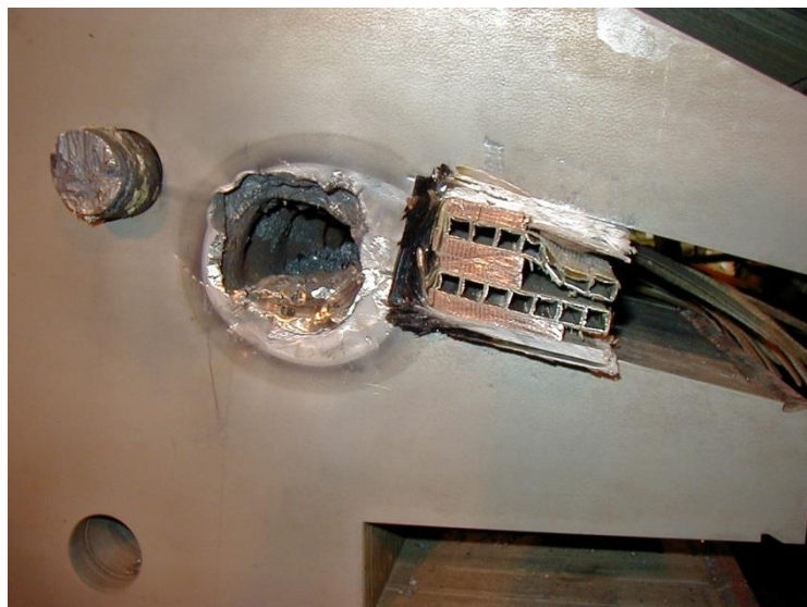
P 2.1 Roztavené jádro statoru (převzato z [43])
