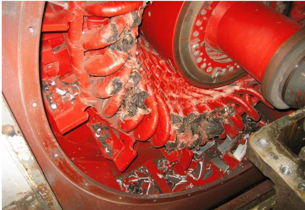
P 1.1 Zničená čela vinutí vadou ventilátoru (převzato z [10])
