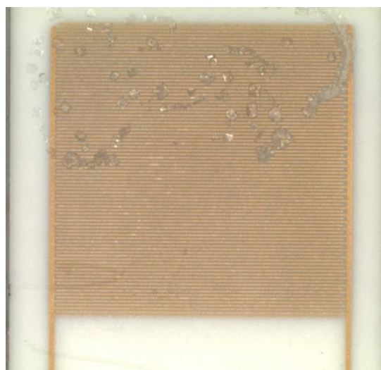
Obr. 4.21 - Vzorek na keramickém substrátu s ochrannou vrstvou parylenu C 5 µm
