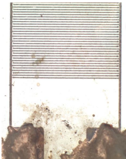
Obr. 4.14 - Vzorek na PET substrátu s ochrannou vrstvou parylenu C 5 µm
