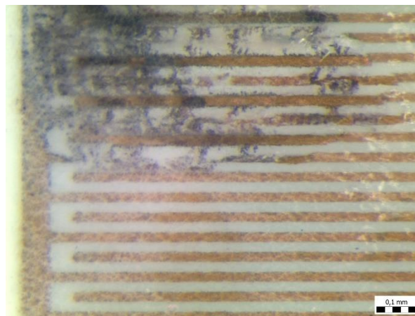
Obr. 4.24 - Tvorba dendritů mezi vodivými strukturami – snímek 1
