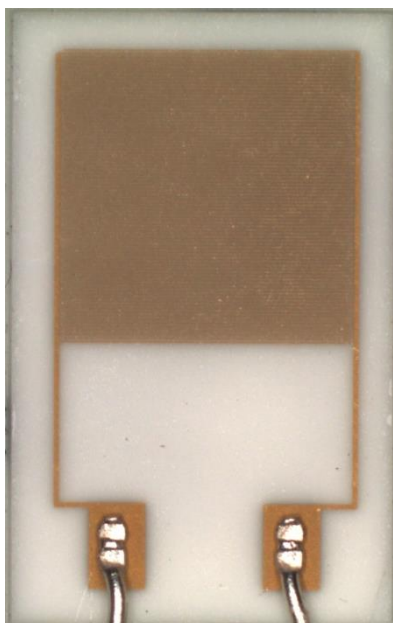
Obr. 3.13 - Vzorek s ochrannou vrstvou parylenu C 20 µm
