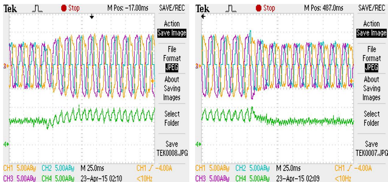
Obr. 5.31., 5.32. Průběh I_1 , I_2 , I_3 , I_d při zatížení 800W s regulací na U_{pož}=195V zobrazený začátek a konec poklesu napětí
