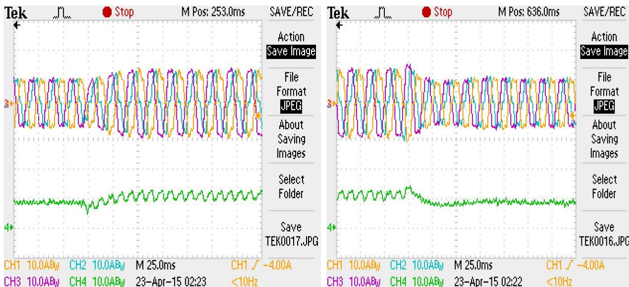
Obr. 5.37., 5.38. Průběh I_1 , I_2 , I_3 , I_d při zatížení 1280W s regulací na U_{pož}=195V zobrazený začátek a konec poklesu napětí
