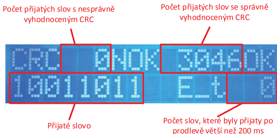
Obr. 6.7: Ukázka zobrazení dat na displeji přijímacího modulu
