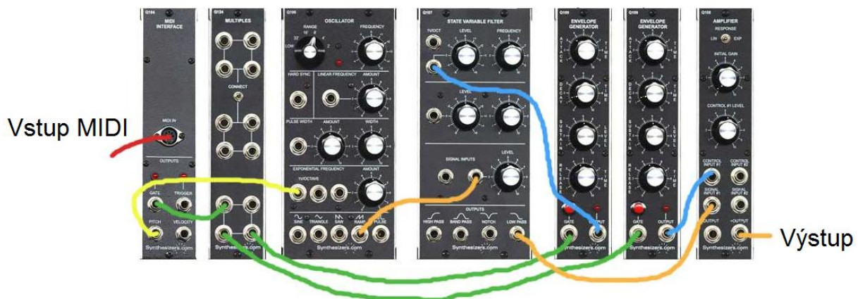
Obr. 5.1 Základní princip subtraktivní syntézy řešený modulárním syntezátorem v tradiční podobě [11]
