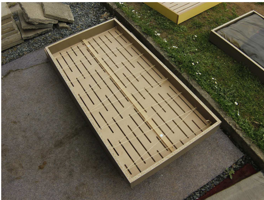
Obr. B.4: Konstrukce pohltivého panelu - síť pro vymezení vzdálenosti od přední desky
