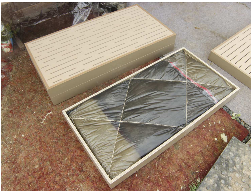
Obr. B.5: Konstrukce pohltivého panelu - celkový pohled
