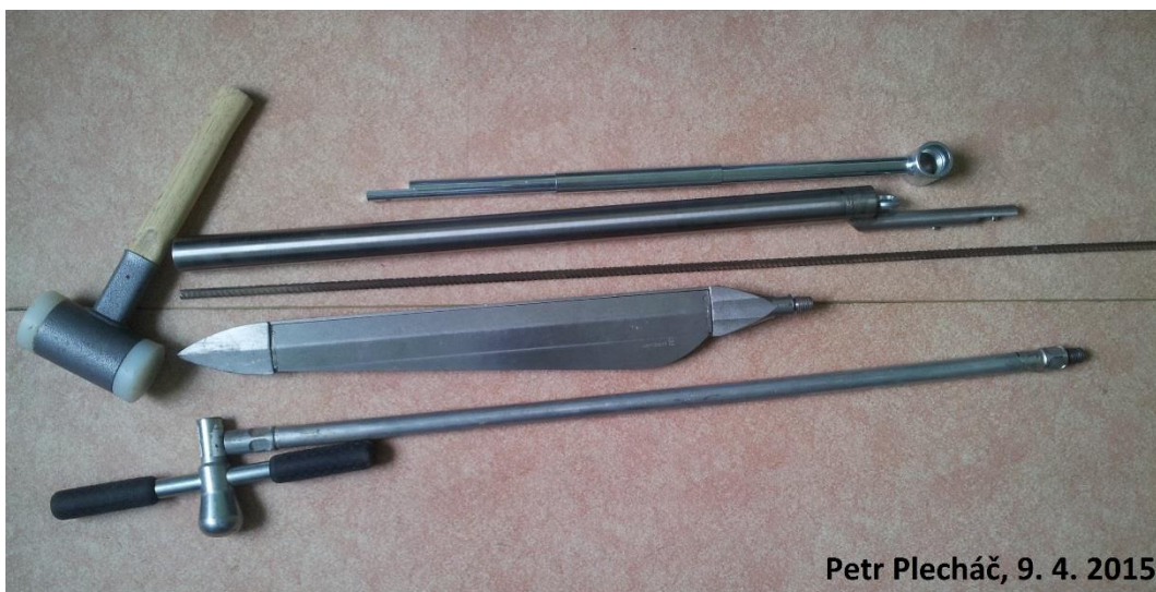
Obr. 16: Použité nářadí při odběru sedimentů (komorový a pístový vzorkovač, kladivo a kovová tyč)
